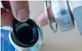
Bild 4: Vorlegering auflegen, Klemmring auflegen, Konusmutter aufschrauben
