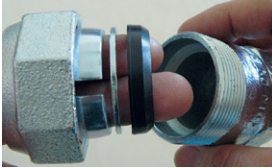
Bild 2: Konusmutter abschrauben, Klemmring und Vorlegering anheben und den Dichtring aus NBR herausnehmen und beiseite legen.
