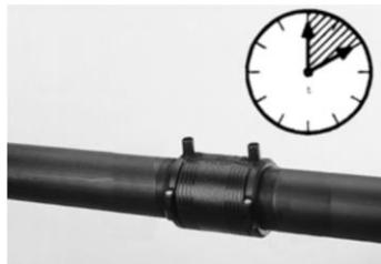
Снимаем фиксирующее приспособление, можно приступать к испытаниям соединения.
