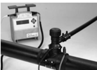
При наличии болтового крепления, необходимо затянуть болты до специальной отметки на седелке.
